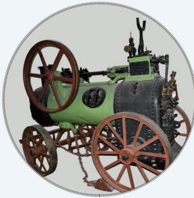
Локомобиль — передвижной паровой двигатель, который использовался для привода различной неподвижной сельскохозяйственной техники. Прототипом какого современного устройства он является?
