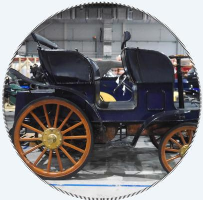
Этот автомобиль конструкции братьев Штевер выпускался с 1899 по 1901 год. Двигатель расположен в задней части машины, а бензобак — над двигателем. Заправочных станций, кстати, в то время не было. Где же можно было купить бензин?
