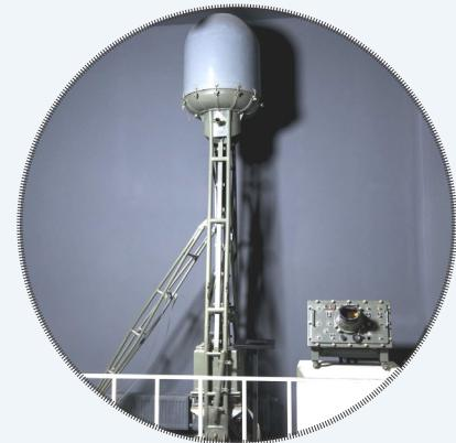
Принцип работы радиолокационной станции «Зарница» основан на отражении электромагнитных волн от объектов. Станция посылает сигнал и улавливает его отражение, таким образом определяя расстояние до объекта. Какое животное использует тот же принцип?
