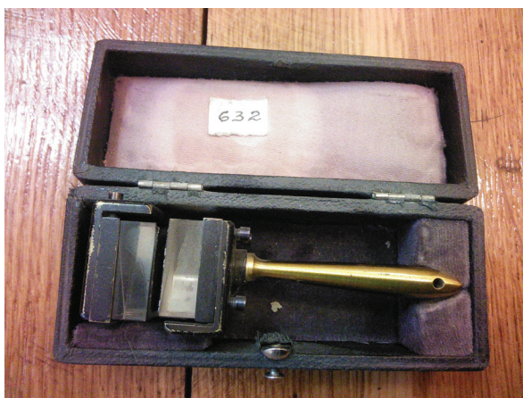
Рис. 3. Конструкции отражательных (зеркальных и призмных) эккеров:
