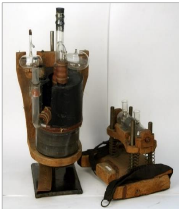
Рис. 2. Портативный газоанализатор конструкции И.М. Сеченова.
